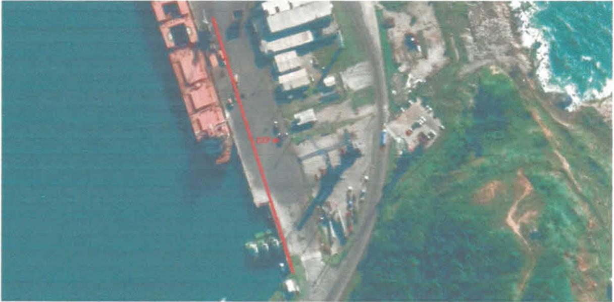
Figura 3 – Trecho de 227 m de tubulação de 8" sob o cais, em destaque.
