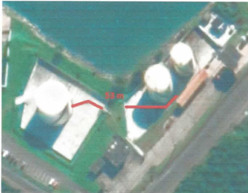
Figura 2 – Trecho de 53 m de tubulação de 8", em destaque.
