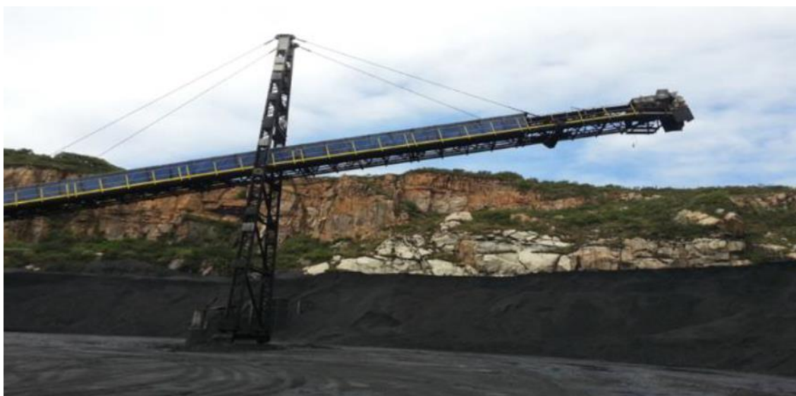
Transportador de Correia TC3 e pátio de estocagem CRB Fonte: PDZ (pg. 162, 2014)
