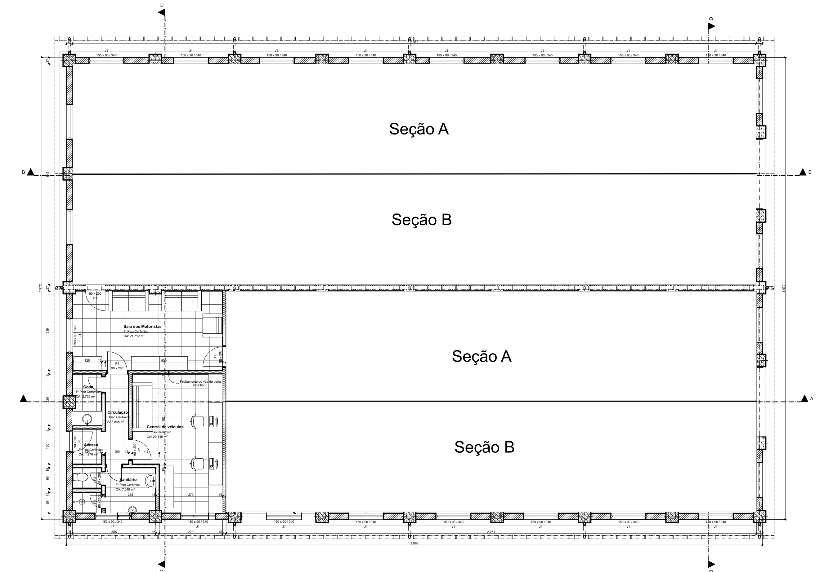
1. Posição das seções de concretagem 1:100
