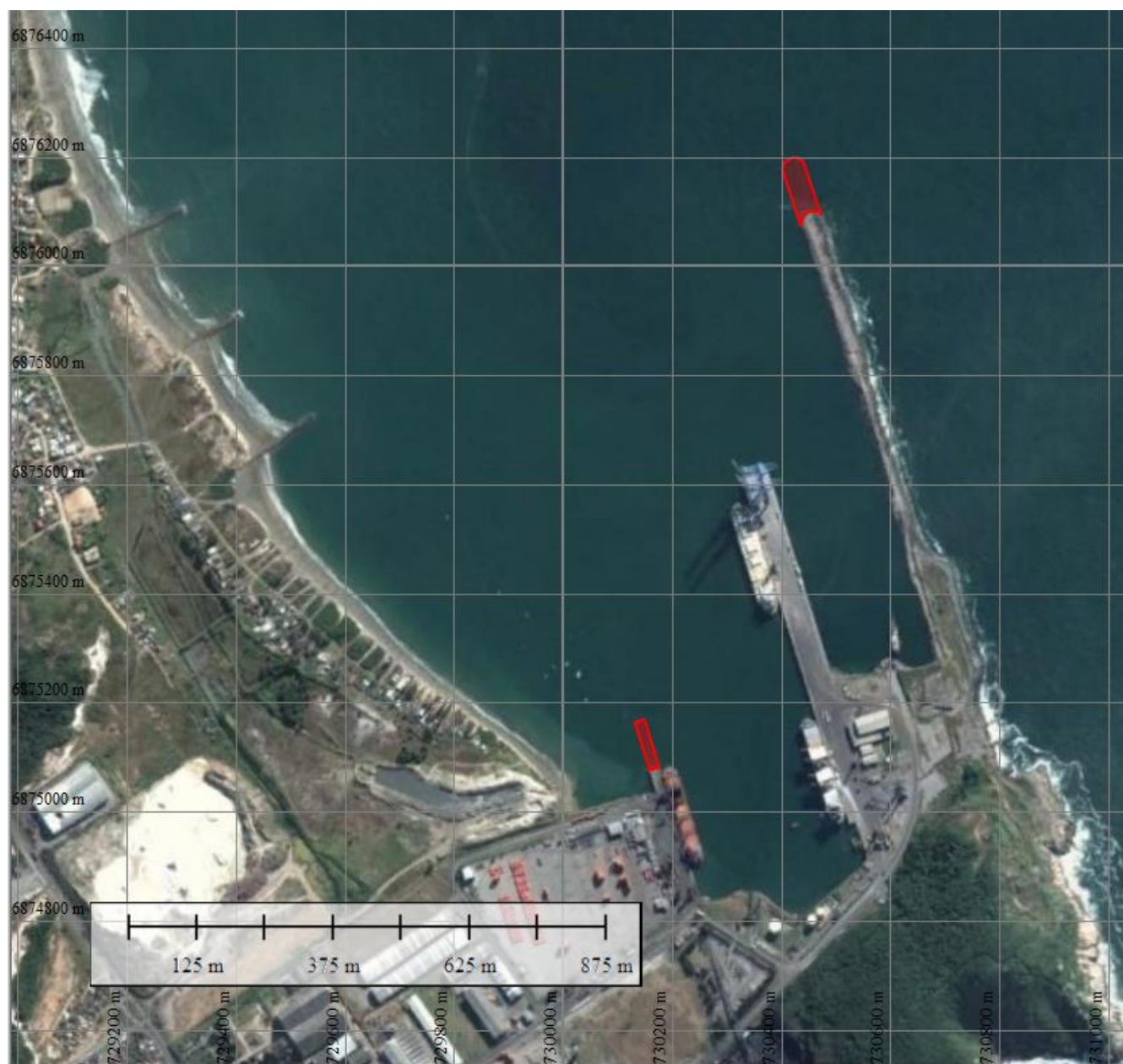
Figura 4: Representação esquemática da alternativa 3 proposta para contenção do assoreamento no berço 3 do Porto de Imbituba.
