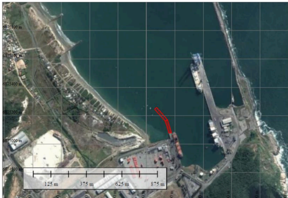
Figura 1. Exemplo de alternativa de obra de contenção de sedimentos, conforme estudo de hidrodinâmica realizado em 2017.
