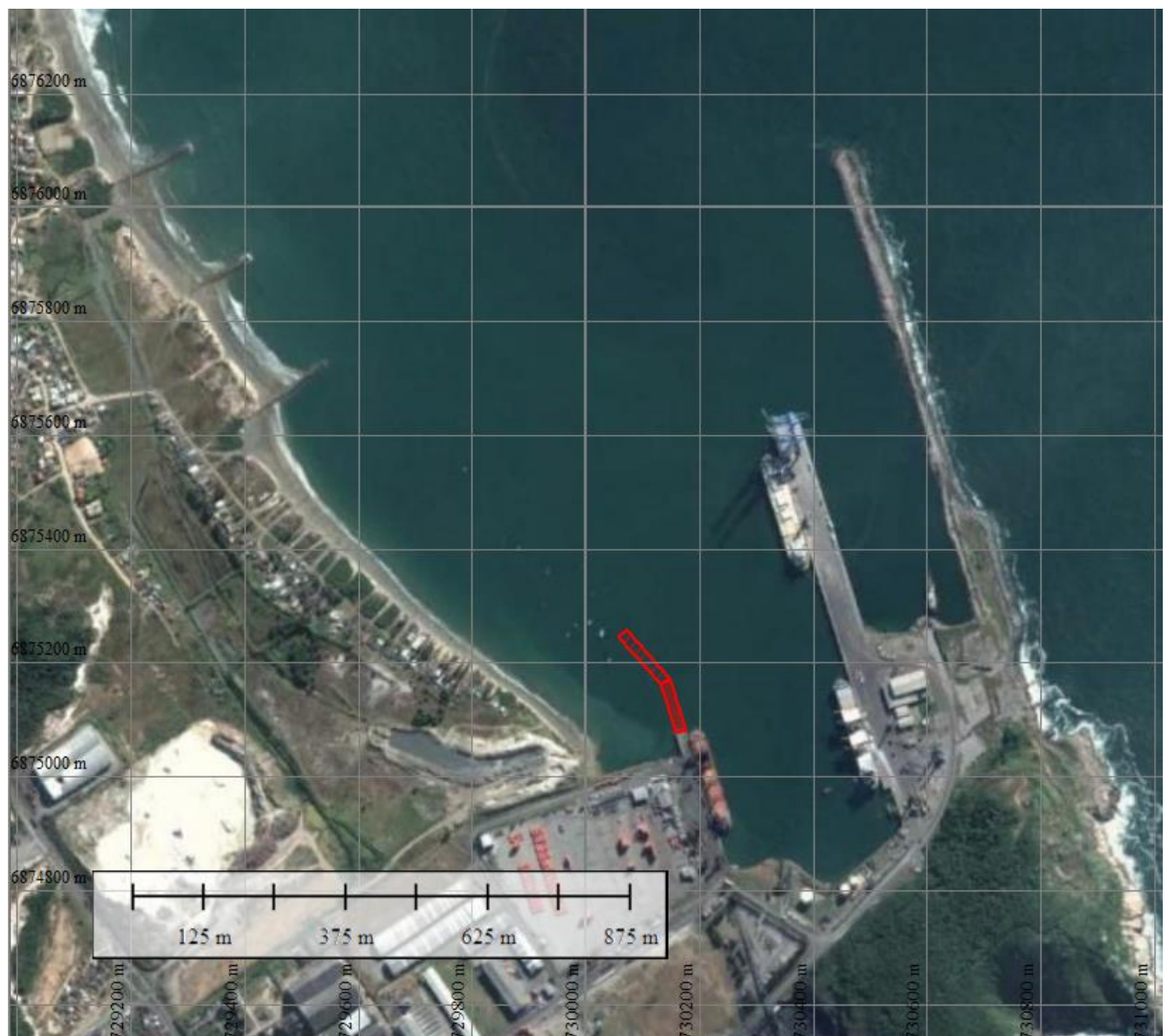
Figura 2: Representação esquemática da alternativa 1 proposta para contenção do assoreamento no berço 3 do Porto de Imbituba.
