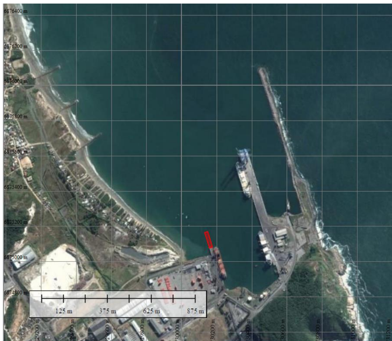
Figura 3: Representação esquemática da alternativa 2 proposta para contenção do assoreamento no berço 3 do Porto de Imbituba.
