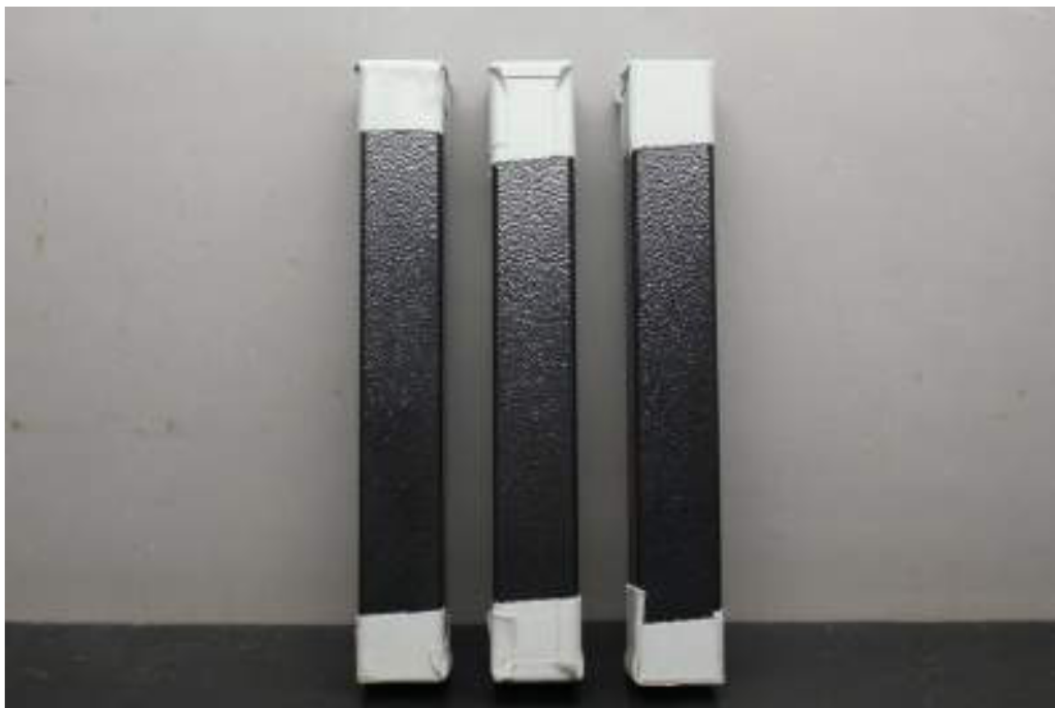
Amostras com 768 horas de exposição Sem alterações.
