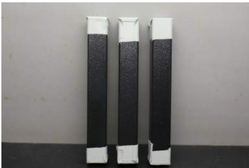
Amostras com 456 horas de exposição Sem alterações.
