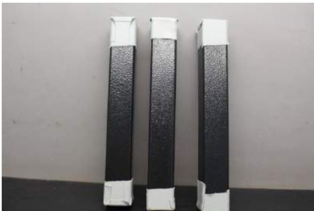
Amostras com 264 horas de exposição Sem alterações.
