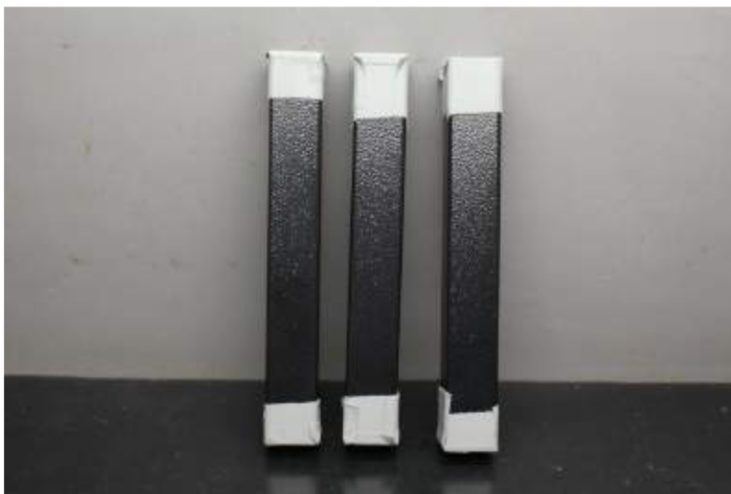
Amostras com 408 horas de exposição Sem alterações.
