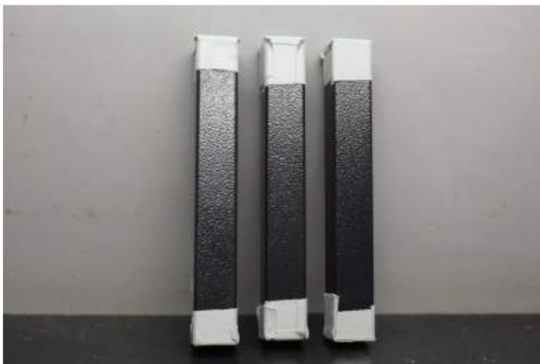
Amostras com 120 horas de exposição Sem alterações.
