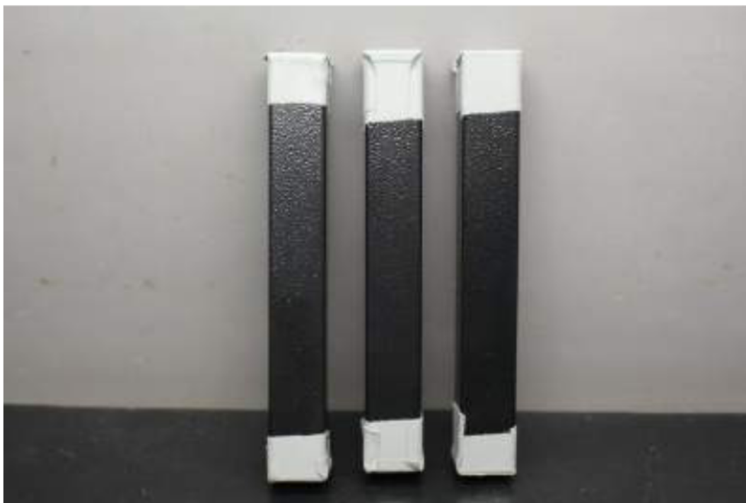
Amostras com 744 horas de exposição Sem alterações.
