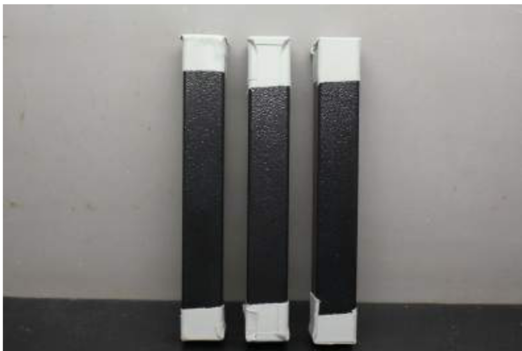
Amostras com 48 horas de exposição Sem alterações.
