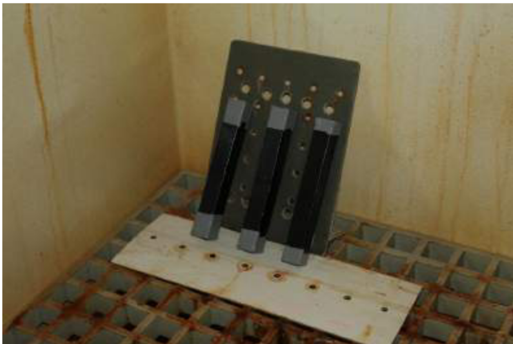
Disposição das amostras na câmara de ensaio.
