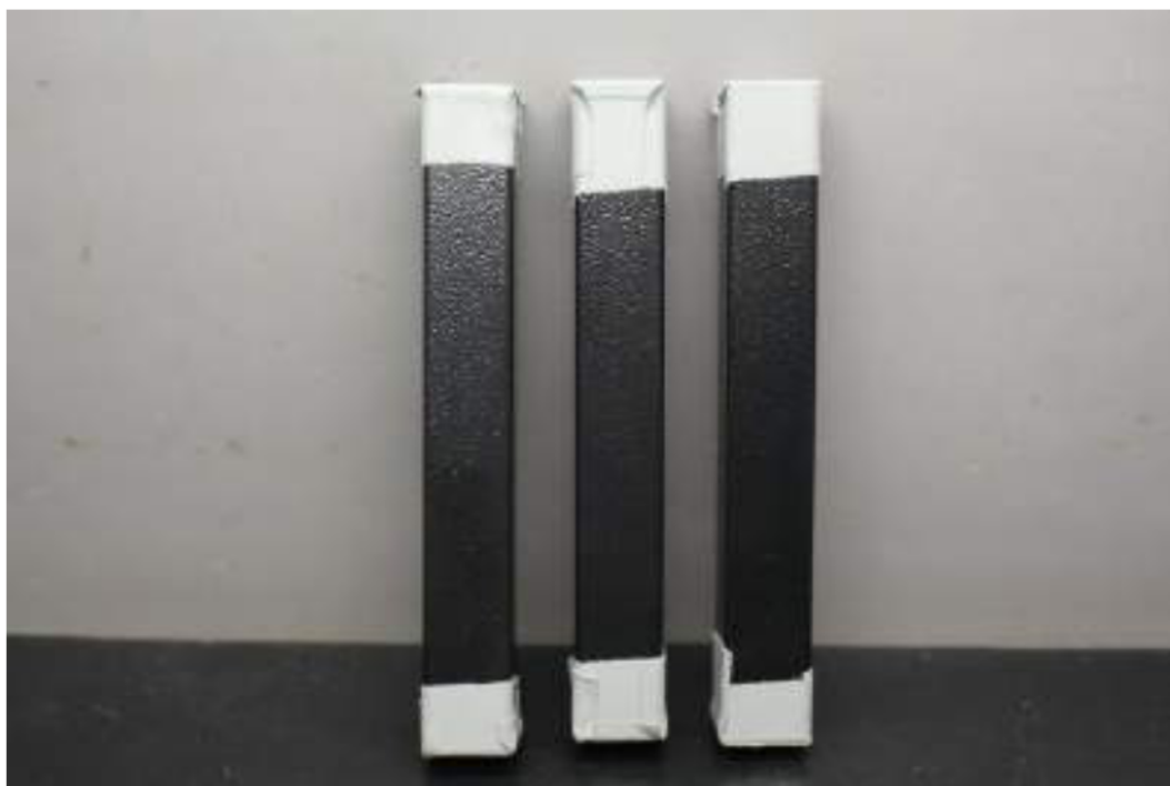
Amostras com 624 horas de exposição Sem alterações.
