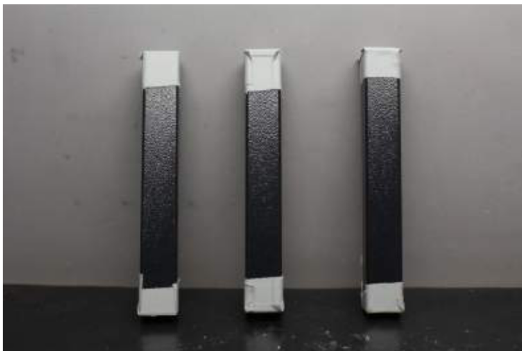
Amostras com 240 horas de exposição Sem alterações.
