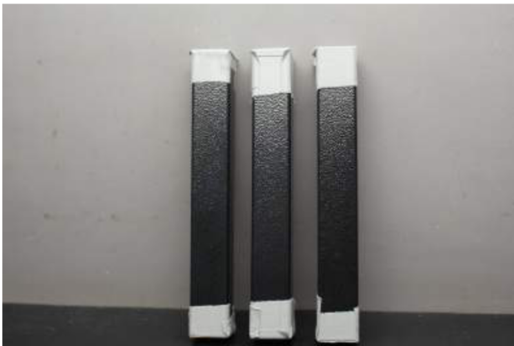
Amostras com 600 horas de exposição Sem alterações.
