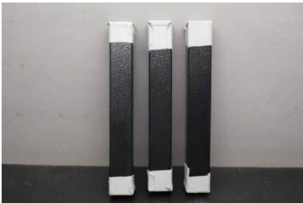
Amostras com 96 horas de exposição Sem alterações.
