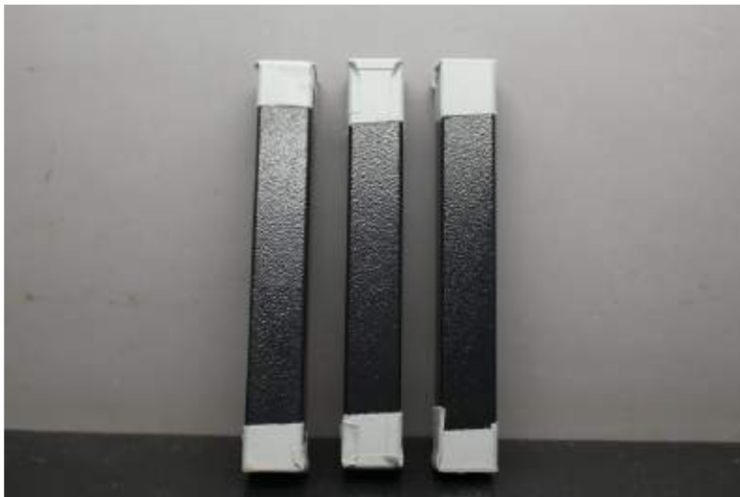
Amostras com 816 horas de exposição Sem alterações.
