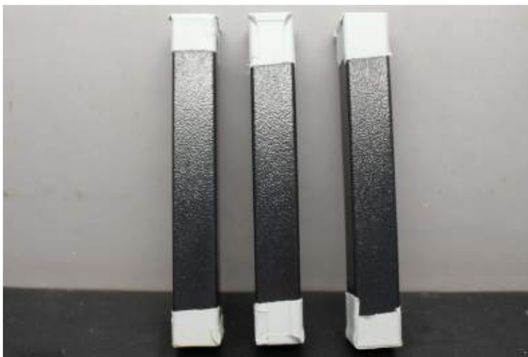
Amostras com 360 horas de exposição Sem alterações.
