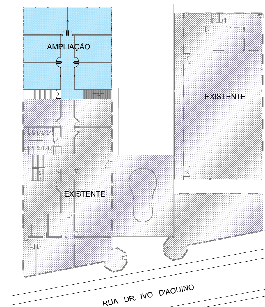
PLANTA DE LOCAÇÃO Escala 1:75
