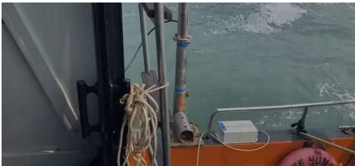
Figura 50 – Estrutura de aço inox fixado na borda da embarcação.
