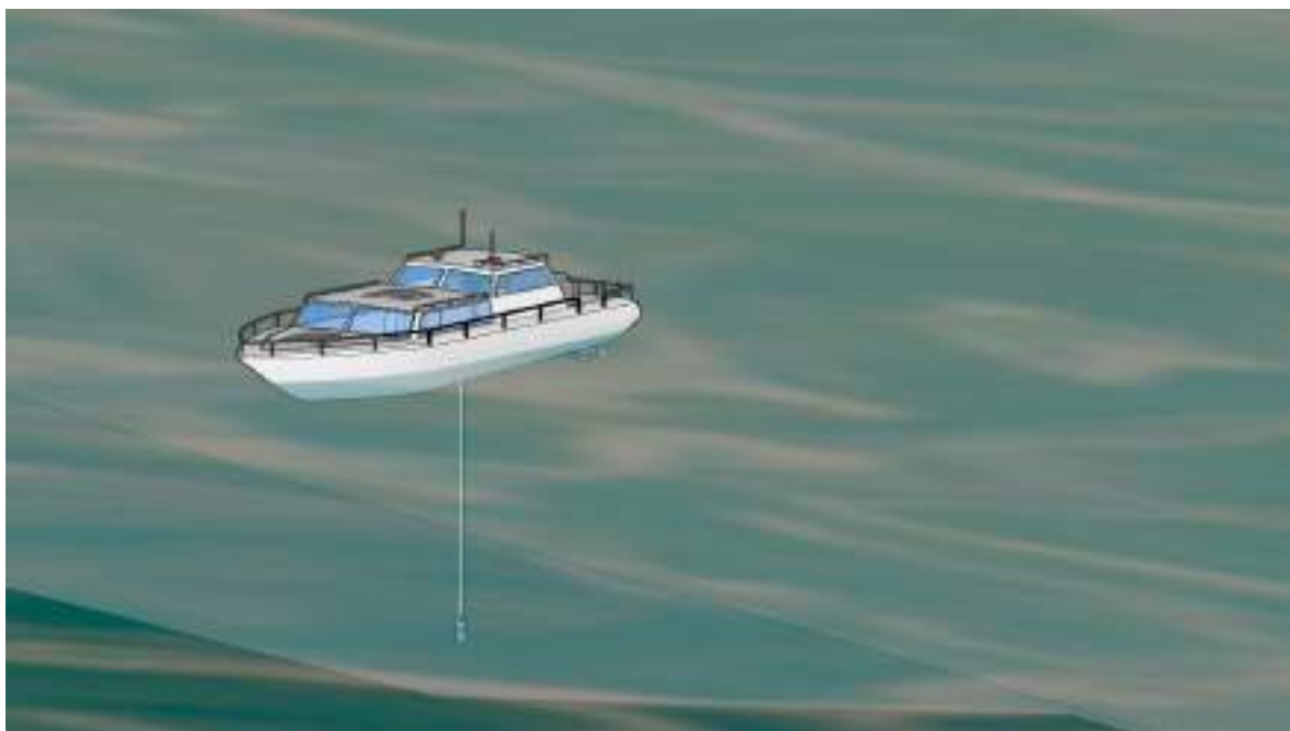
Figura 26 – Imagem Ilustrativa do procedimento de lançamento da velocidade do som.
