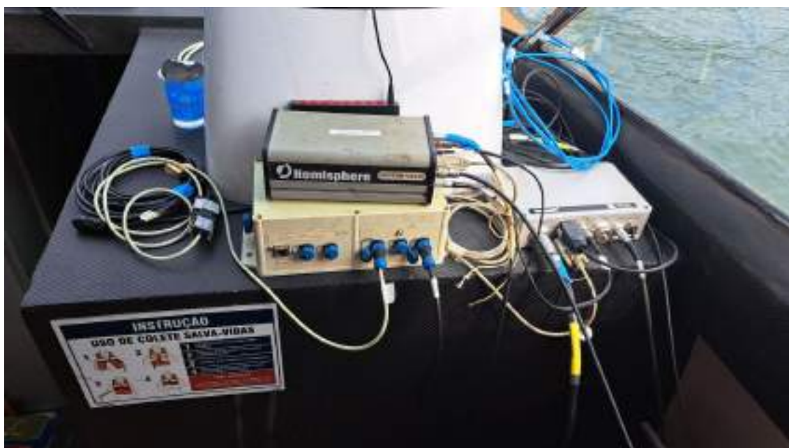
Figura 51 – Console do multibeam NORBIT iWBMS e SBG Ekinox2
