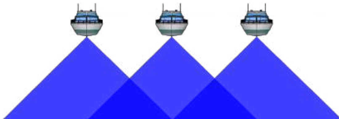
Figura 16 – Recobrimento lateral do ecobatímetro.
