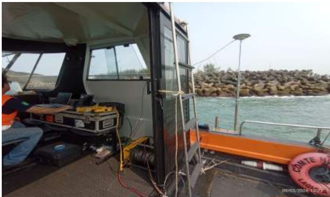
Figura 72 – Momento da operação Side Scan.
