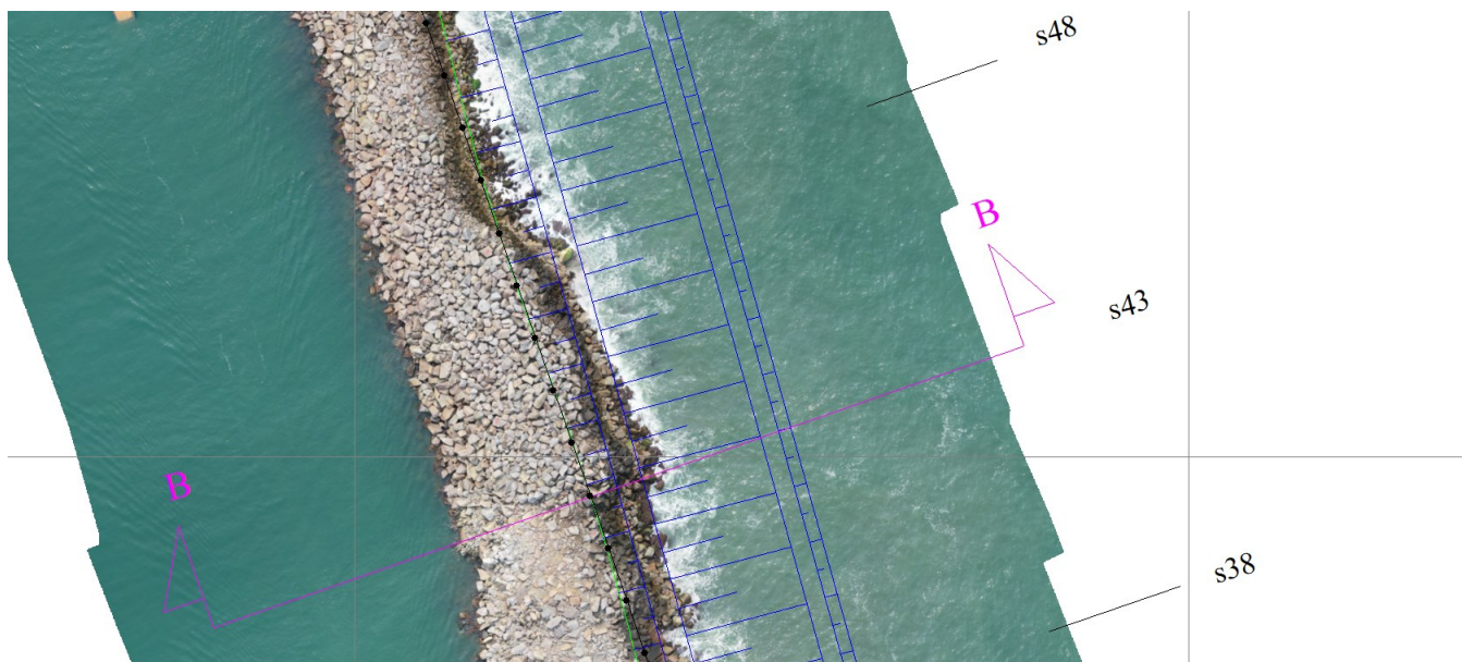
Figura 32 – Avarias de grande monta entre a seção 38 a 48.
