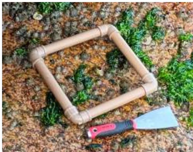
Figura 122 – Delimitador e espátula utilizados para remoção de organismos incrustantes na estrutura do molhe. Fonte: Hidrotopo, 2024..
