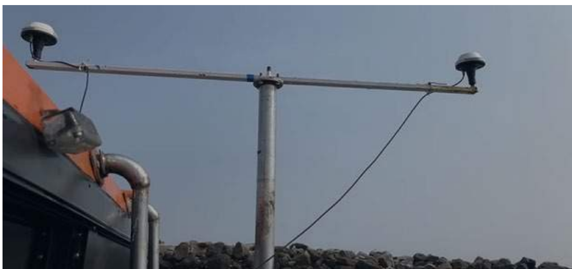
Figura 49 – Antenas DGPS/GIROS montados na embarcação.
