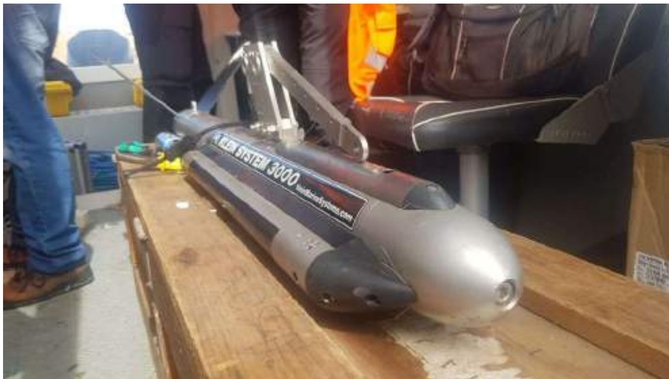
Figura 9: Sonar de varredura lateral utilizado no projeto do Porto de Imbituba: Klein System 3000.
