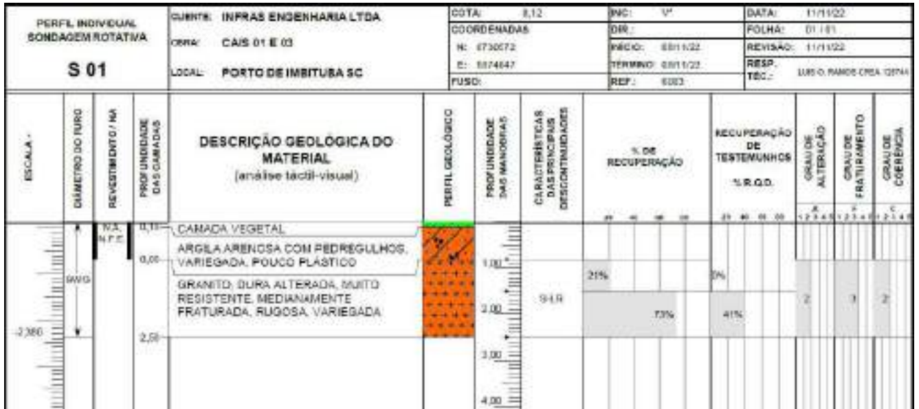
Figura 31: Perfil geotécnico do ponto S01A. (ver anexo)
