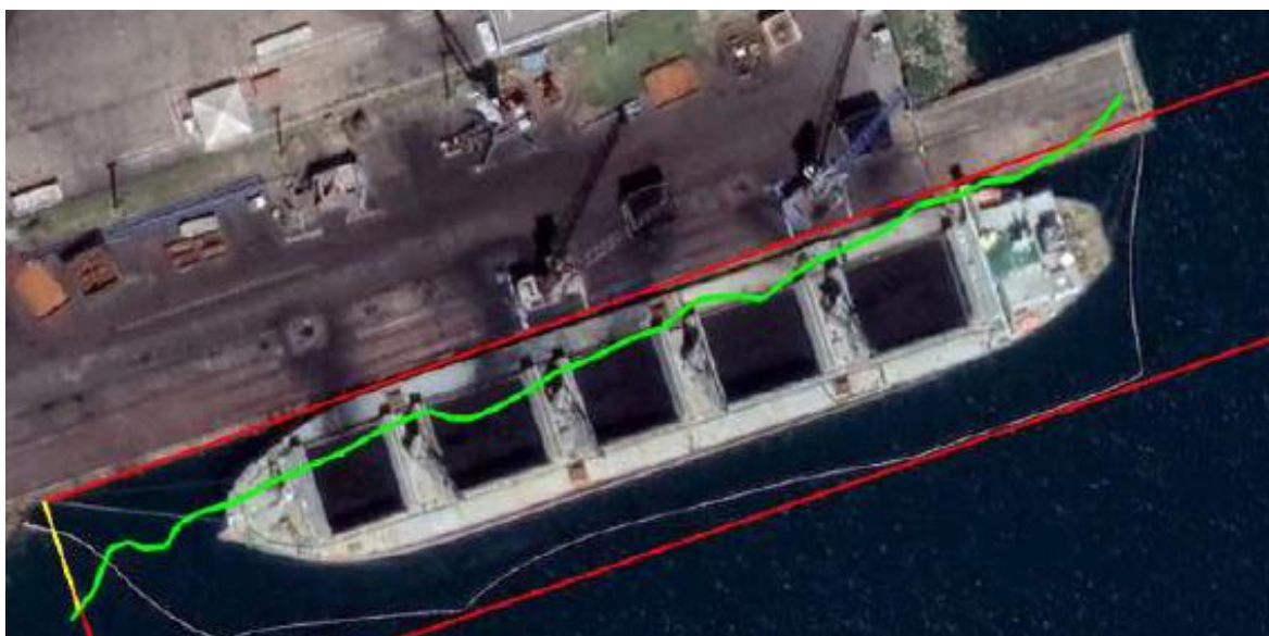
Figura 8 - Alinhamento estimado do pé do enrocamento
