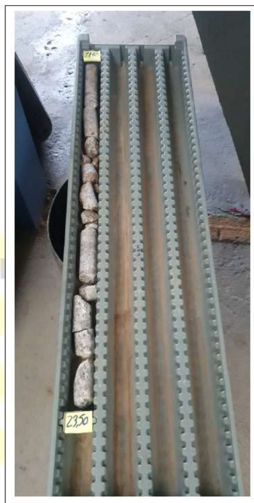
Figura 33: Fotos da execução e testemunhos do ponto S03.
