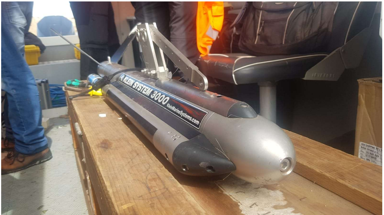
Figura 9: Sonar de varredura lateral utilizado no projeto do Porto de Imbituba: Klein System 3000.
