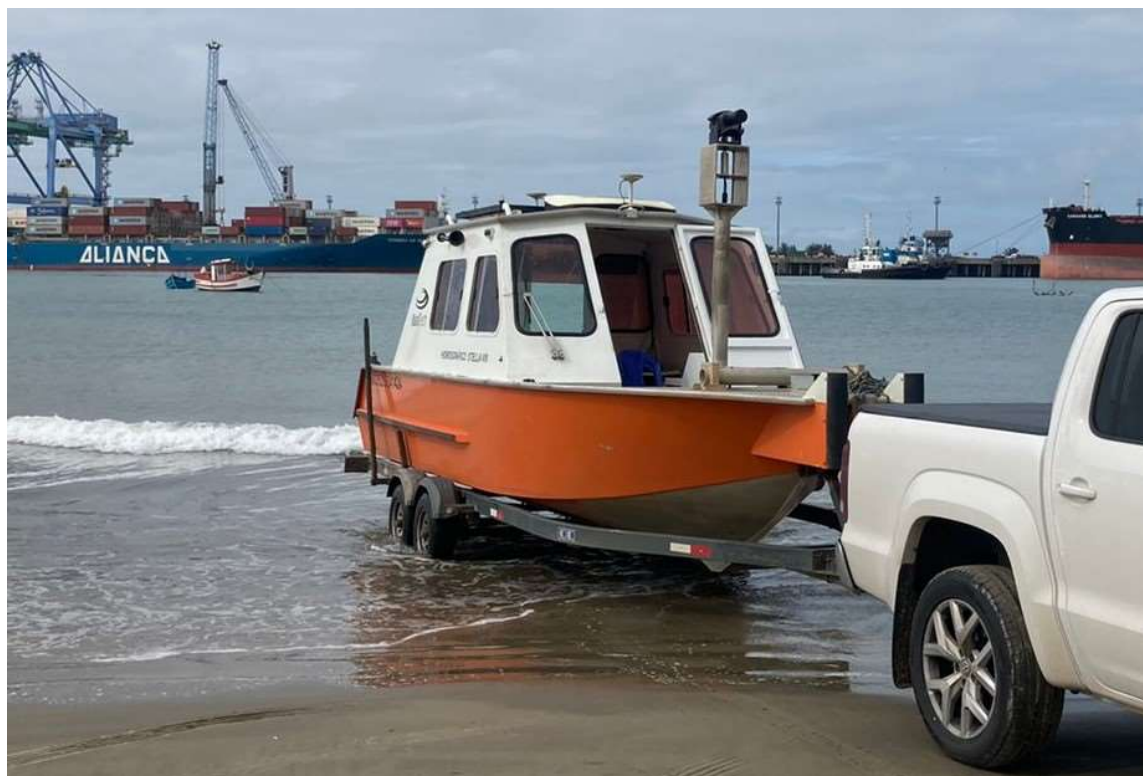
Figura 5: Foto da embarcação utilizada durante o levantamento no Porto de Imbituba. Sonar multifeixe instalado na parte dianteira da embarcação
