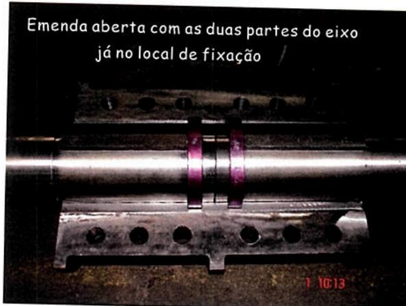
Emenda aberta com as duas partes do eixo já no local de fixação
