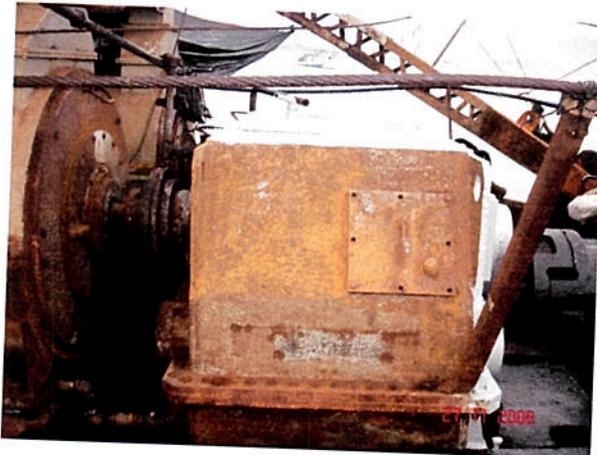
Caixa redutora do eixo do desagregador
