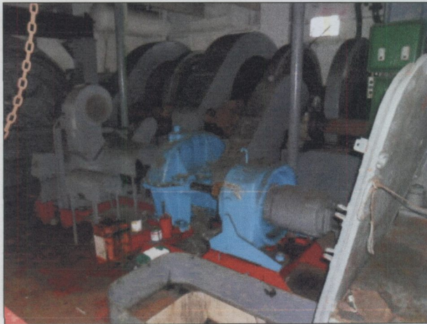
Foto 39-Guinchos da lança de dragagem/lanças de arinque.
