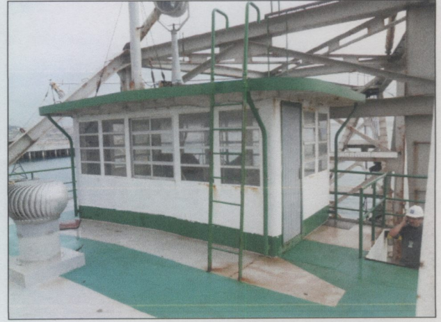
Foto 16-Casa de comando de dragagem, sobre a superestrutura avante.
