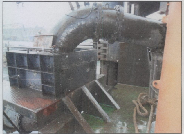
Foto 4- Vista do cachimbo (“swivel”) da descarga.
