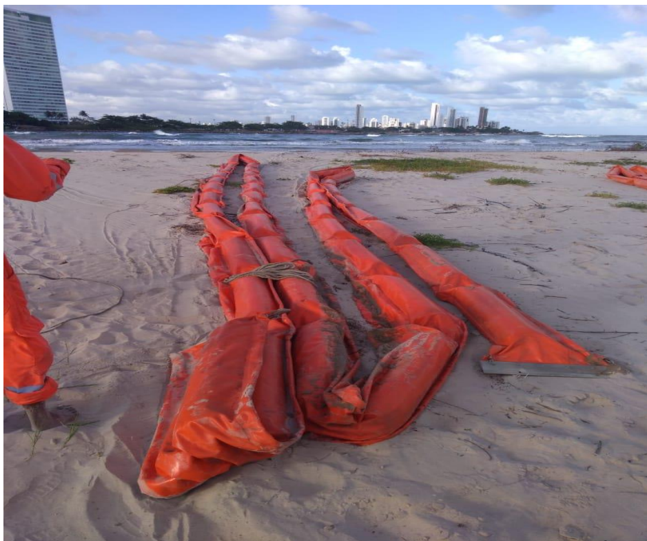
Foto 0.37: Desmobilização de barreiras de contenção (28/10/19).
