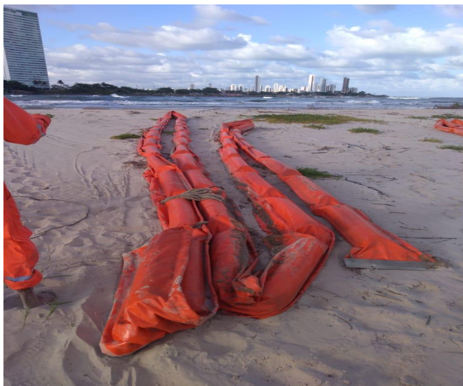
Foto 3.37: Desmobilização de barreiras de contenção (28/10/19).
