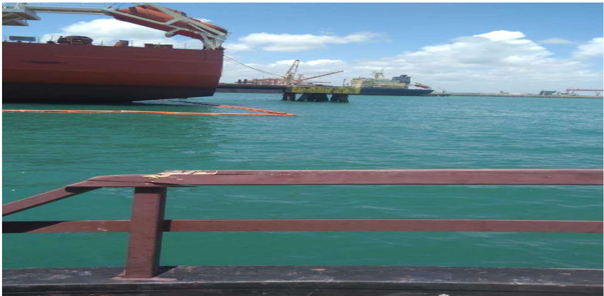
Barreira de contenção para proteção de navio atracado
