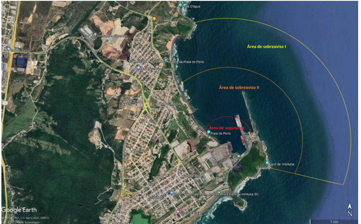
Figura 2 - Área do Porto de Imituba e adjacências, com demarcação das áreas de controle para o monitoramento das baleias e a operação de martelo vibratório e perfuratriz.
