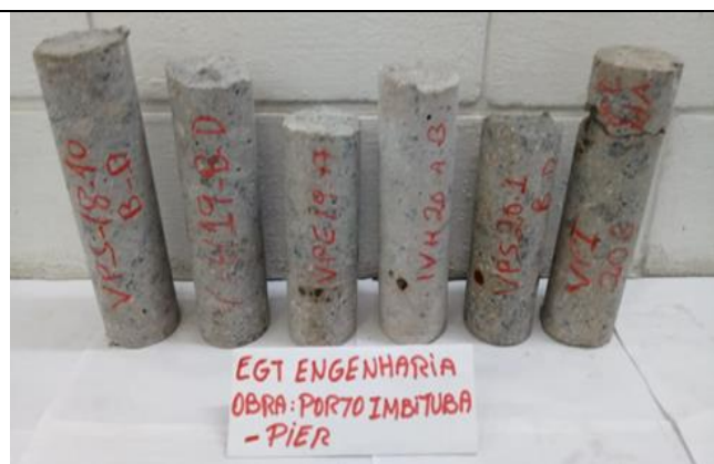
TESTEMUNHOS VIGAS DO PIER.
