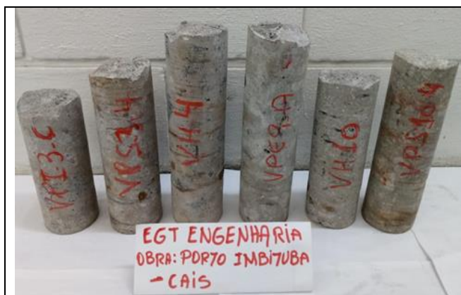
TESTEMUNHOS VIGAS DO CAIS.
