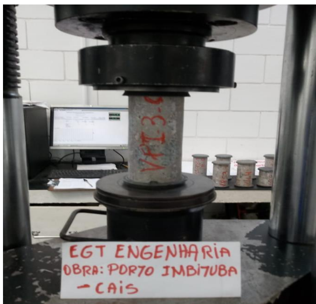
Ruptura do corpo de prova testemunho da VIGA V-PI-3C, submetido ao ensaio de resistência à compressão.
