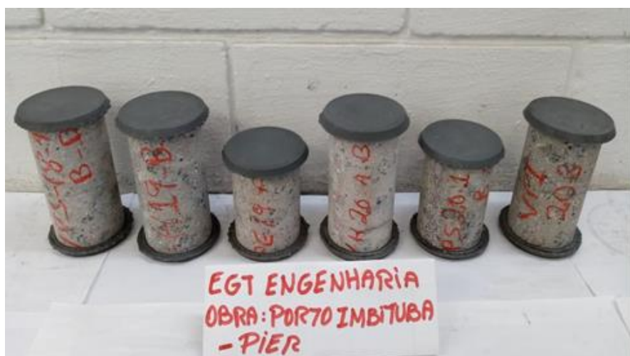
Corpos de prova preparados, para o ensaio de resistência à compressão (piér)
