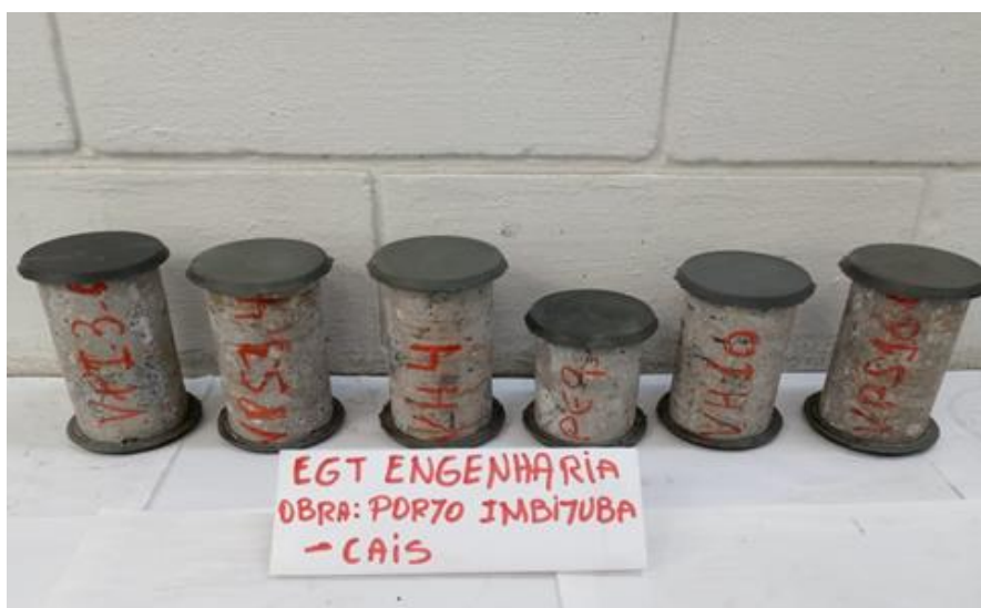
Corpos de prova preparados, para o ensaio de resistência à compressão (cais)
